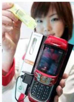
Gambar 5. Proses pengisian daya dengan baterai cair
